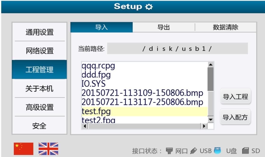
步骤8. 在弹出的对话框中输入下载密码和开发者密码（仅当工程有下载密码或开发者密码时），点击**确定**，即可将 U 盘中的工程文件下载至 HMI。
